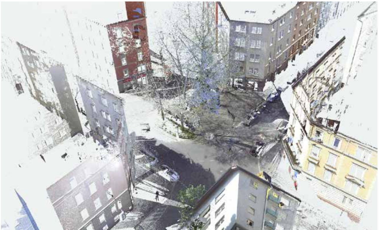
Abb. 4: Punktwolke basierend auf einem 3D-Laserscan einer Kreuzung im Stuttgarter Westen („Gutenberg-Plätzle“) als Ausgangsbasis für die Entwicklung des digitalen Zwillings.
